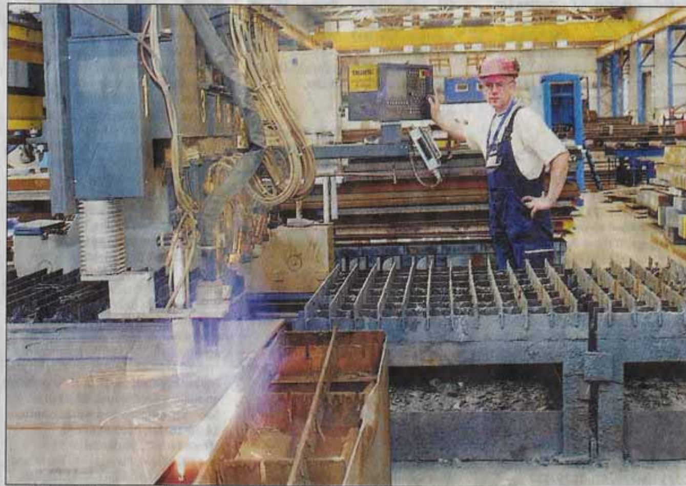
Karl-Heinz Weißer von der Firma Blume Stahlservice an einer Brennschneidemaschine. Sie teilt im Lichtbogenverfahren bis zu 30 Zentimeter dicke Bleche.
