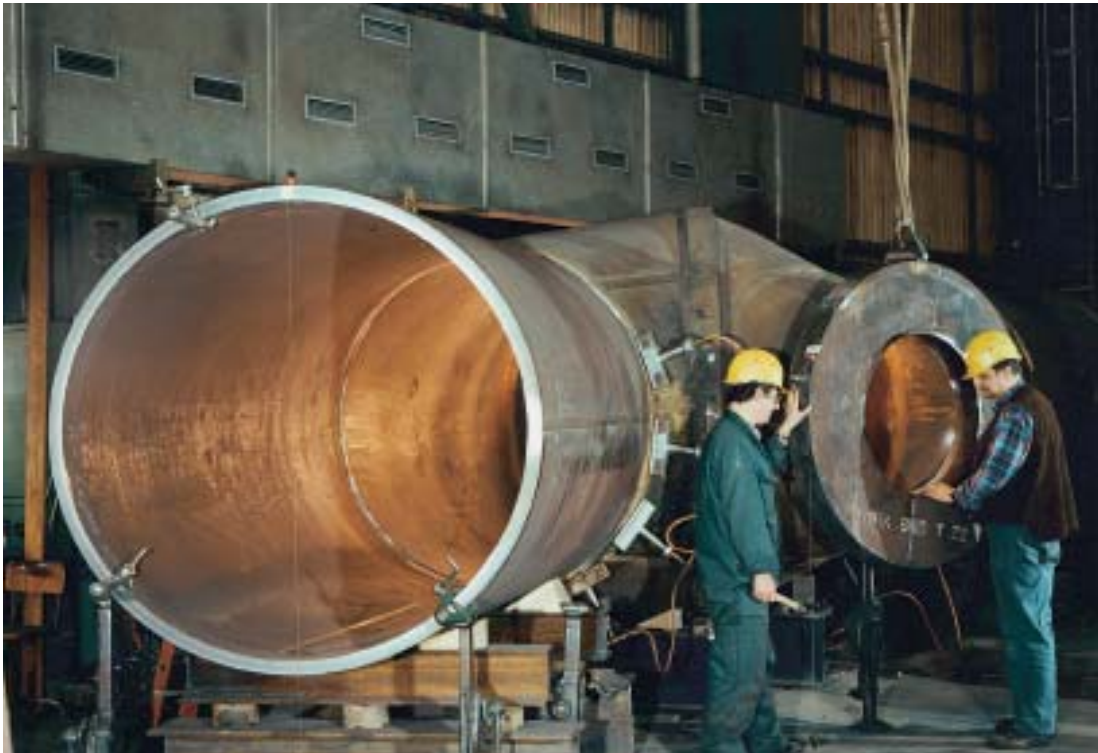
Bild 7: Rohrschüsse aus DILLIMAX 690 für Turbinen-Ringleitungen von Wasserkraftwerken (Bild mit freundlicher Genehmigung der Firma Sulzer Hydro Ltd., Zürich, Schweiz)
